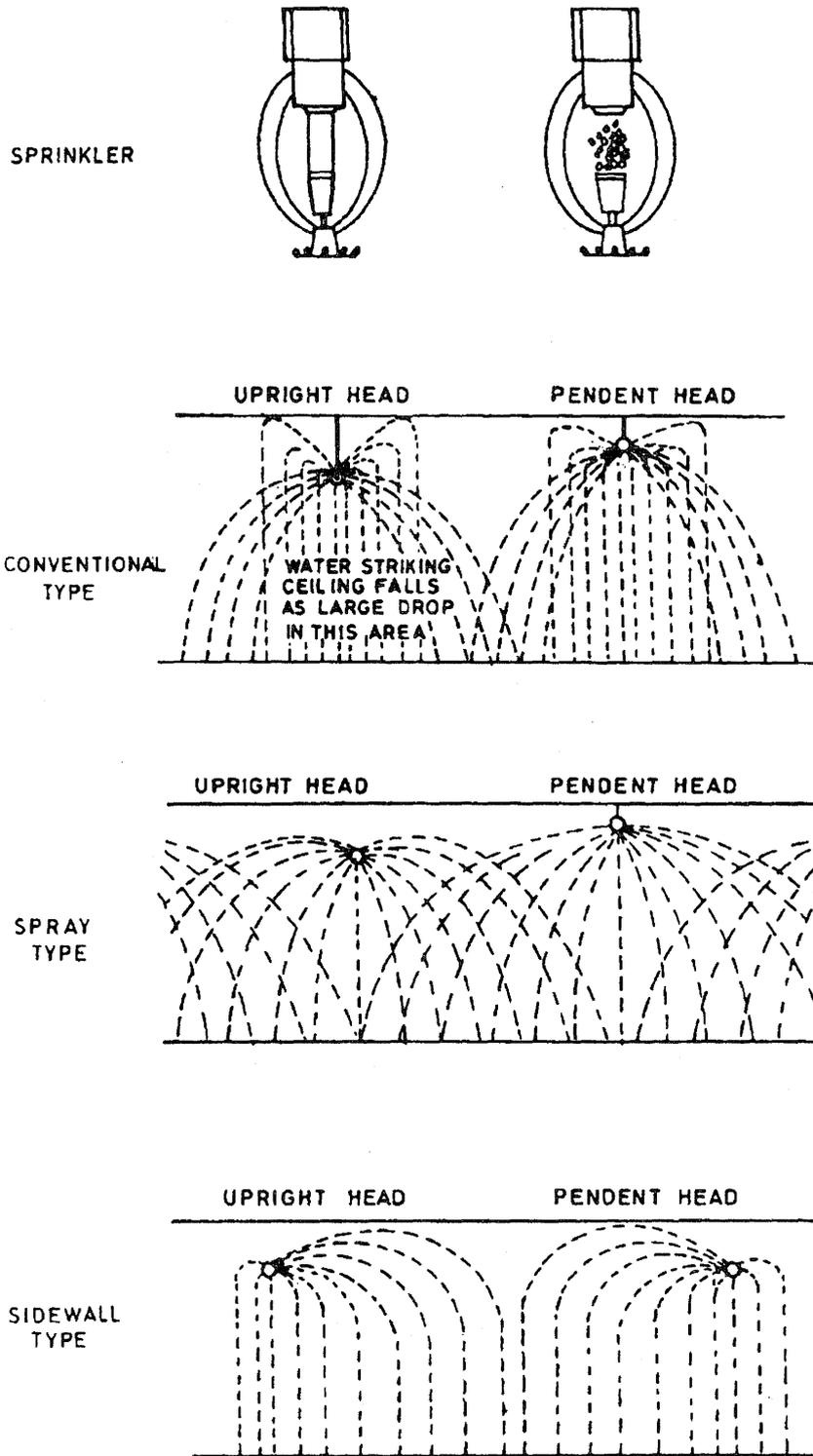
FIG. 30 TYPE OF SPRINKLERS
